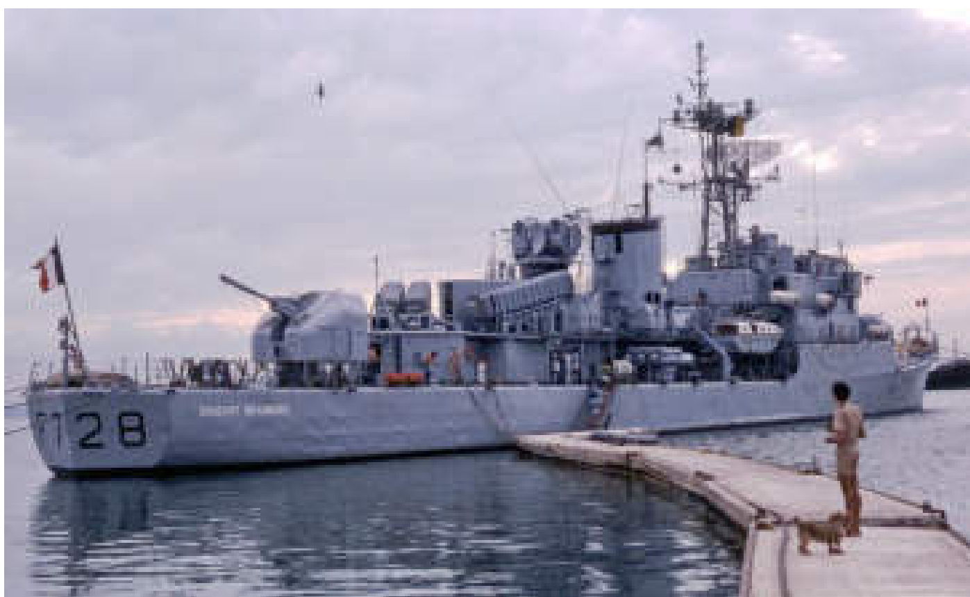
L'avisos-escorteur F 728 Doudard de Lagrée en 1979. Si une des trois tourelles de 100 mm a été débarquée, l'armement a été renforcé avec quatre conteneurs pour missiles MM-38 Exocet . (Photo Marc Champenois)
