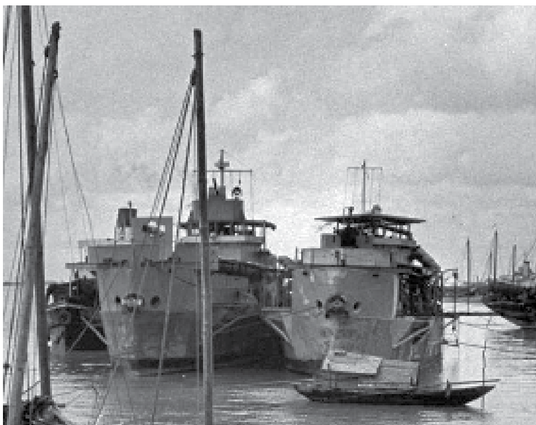
Port de Saigon 1948 : deux LCI(L) modèle britannique à passerelle basse, probablement les LCI 201 et 109. On remarque les premières modifications introduites par l'arsenal de Saigon : la passerelle de navigation du LCI de gauche est surmontée d'un poste de mitrailleuse qui n'a pas encore été installé sur le bâtiment de droite dont la passerelle est seulement surmontée d'une toile de protection. (DR)
